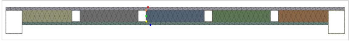
Şekil 5.30. SHS elemanlarla oluşturulan model üzerinde okunan sıcaklık değerlerinin noktalarının belirtilmesi.
