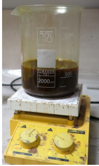
Şekil 4.19 : Sekonder anot çamurunun kral suyu liçi sırasında deney düzeneği.
