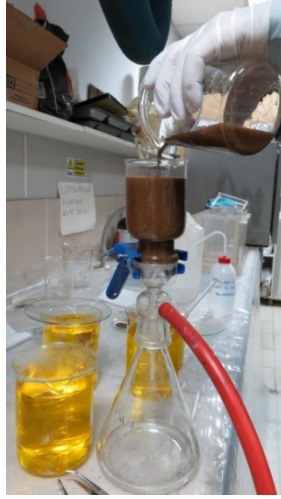
Şekil 4.22 : Kral suyu liçi sonrası sodyum metabisülfid ile çöktürülen altının membranlı vakumlu nücede süzölme deney düzeneđi.
