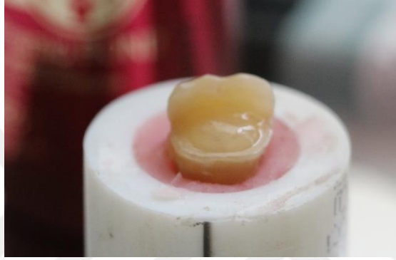
Şekil 3.22. Selektif pürüzlendirme yapılan örnek dişe bonding ajan uygulaması
