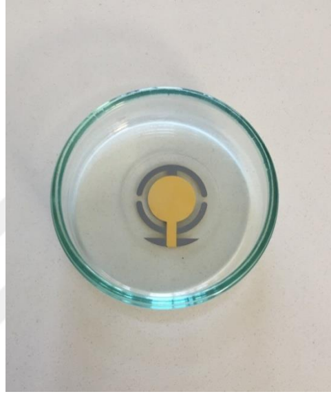
Şekil 3.3. Alil merkaptan modifikasyonundan sonra etil alkol ile yıkanmış ve azot atmosferinde kurutulmuş QCM çip.
