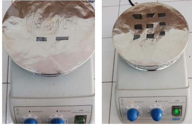
Şekil 3.251. Alüminyum kontaklı p-tipi silisyum wafer ve polimer filmi kaplandıktan sonra aliminyum buharlaştırılarak üst kontağı yapılarak ölçüme hazır numuneler
