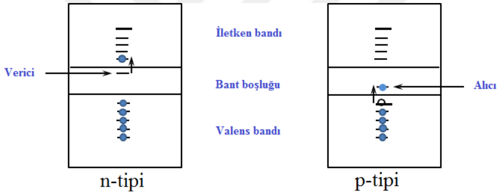
Şekil 1.14. n vep tipi yarı iletkenlerde değerlik bandından iletim bandına elektron transferi
