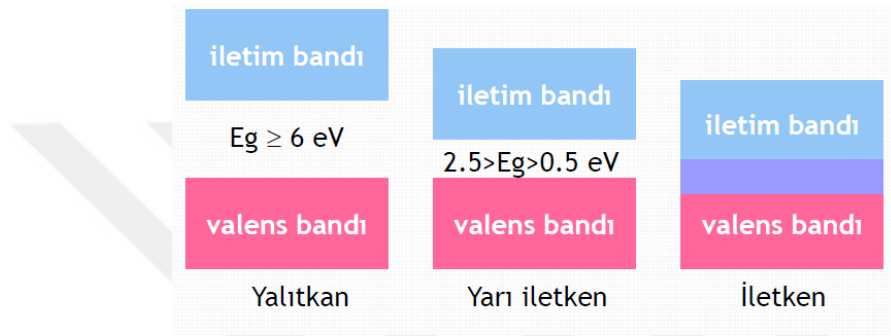
Şekil 1.9. Yalıtkan, yarı iletken ve iletkenler için enerji-band diyagramları
