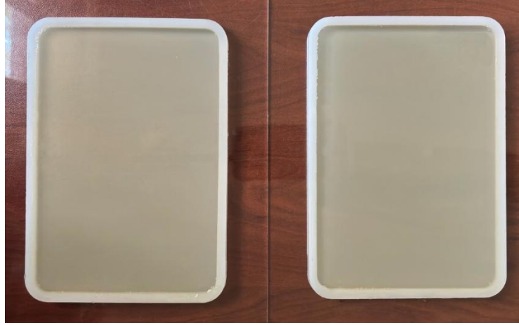
Görsel 3.9. Yüzeyde Oluşan Hava Kabarcıklarının Alınması
