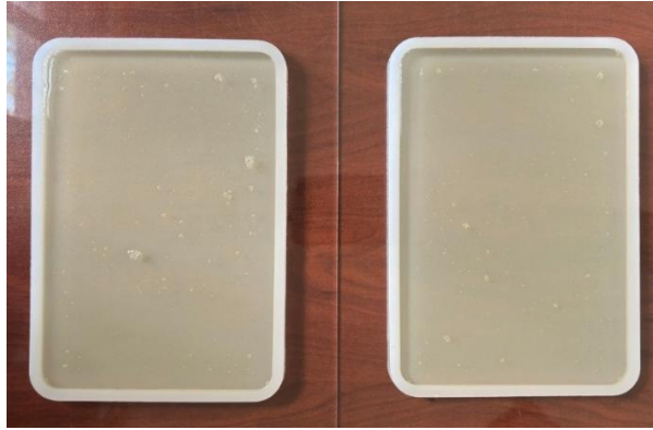
Görsel 3.8. Jel Karışımın Kalıplara Dökülmesi
