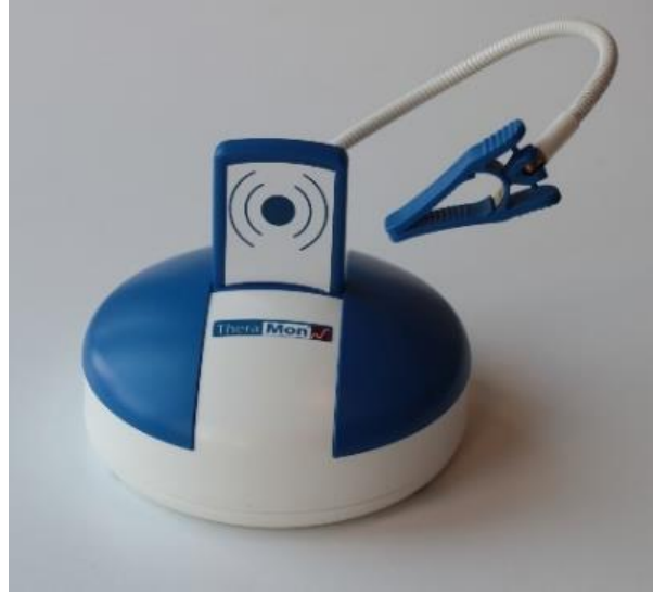
Şekil 2-6: TheraMon sisteminde radyofrekans algılama teknolojisi bulunan okuyucu ünite.
