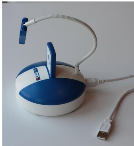
Şekil 3-1: TheraMon okuyucu üniteye bağlı mikrosensör tutucu uç ve USB bağlantı kablosu.
