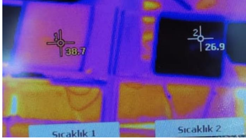
Şekil 7.36. Ağırlıkça %0,2 oranında levha kanatçıklı \text{TiO}_2 -su nanoakışkan soğutmalı ve soğutmasız panellere ait ön taraftan çekilen termal kamera görüntüsü
