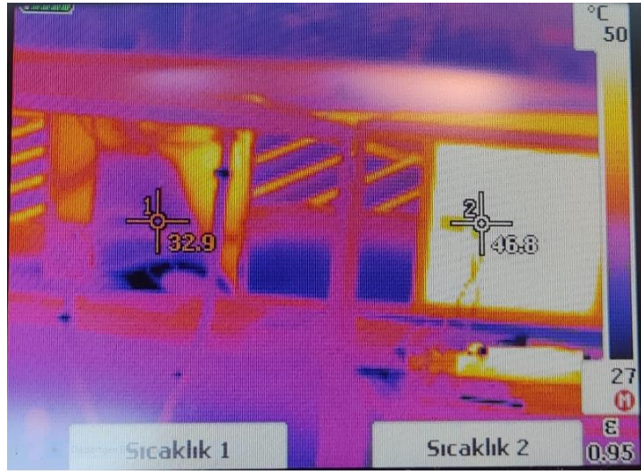
Şekil 7.21. Ağırlıkça %0,2 oranında levha kanatçıklı Al_2O_3 -su nanoakışkan soğutmalı ve soğutmasız panellere ait arka taraftan termal kamera görüntüsü
