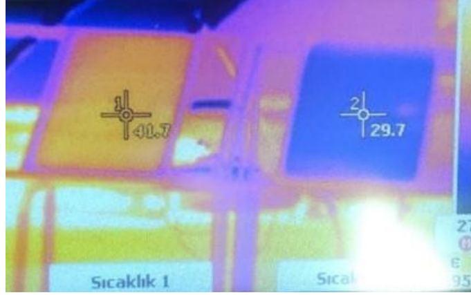
Şekil 7.42. Ağırlıkça %0,6 oranında levha kanatçıklı \text{TiO}_2 -su nanoakışkan soğutmalı ve soğutmasız panellere ait ön taraftan çekilen termal kamera görüntüsü
