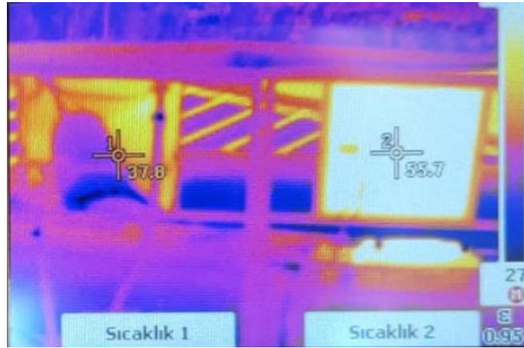
Şekil 7.24. Ağırlıkça %0,4 oranında levha kanatçıklı \text{Al}_2\text{O}_3 -su nanoakışkan soğutmalı ve soğutmasız panellere ait arka taraftan çekilen termal kamera görüntüsü
