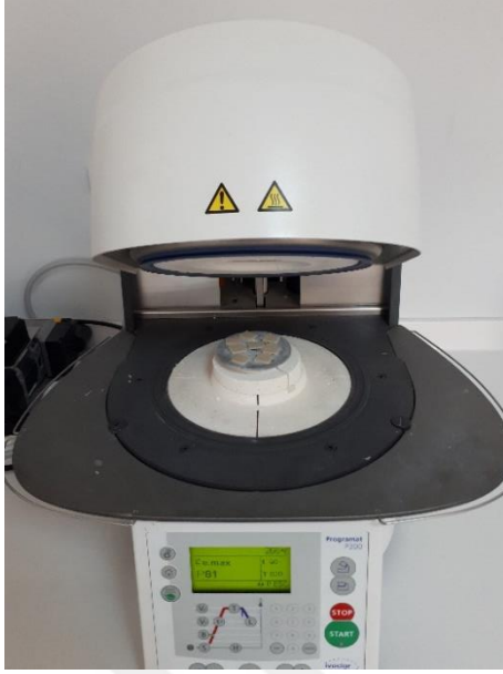
Resim 3.8. Lityum disilikat ve zirkonya ile güçlendirilmiş lityum silikat seramiklerin kristalizasyonu ve kristalizasyon fırını
