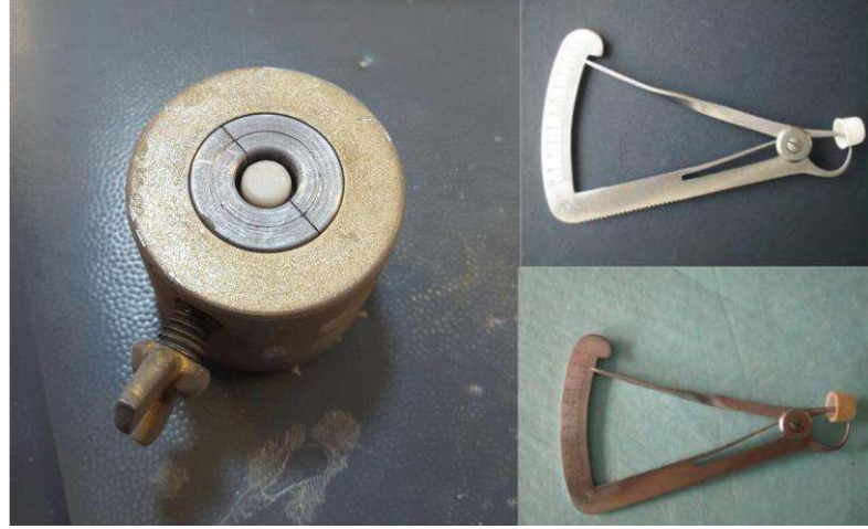
Resim 2: Standardizasyon için kullanılan kalıp / Kumpasla ölçüm
