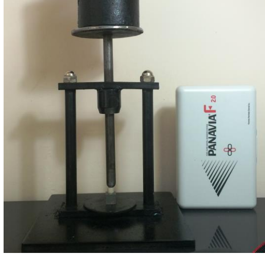
Resim 11: Simantasyon işleminde kullanılan siman ve ağırlık düzeneği
