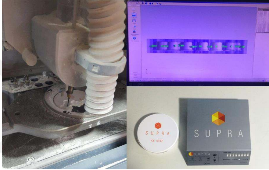
Resim 5: Non-HIP zirkonya blok kullanılarak kuronların üretimi
