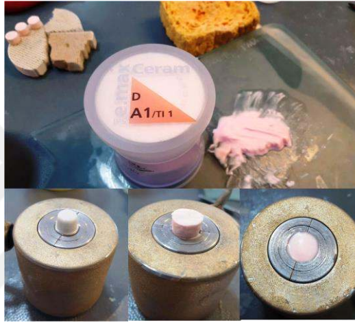
Resim 8: Uygulanan üstyapı porseleni ve dış yapı standardizasyonu için oluşturulan metal kalıp
