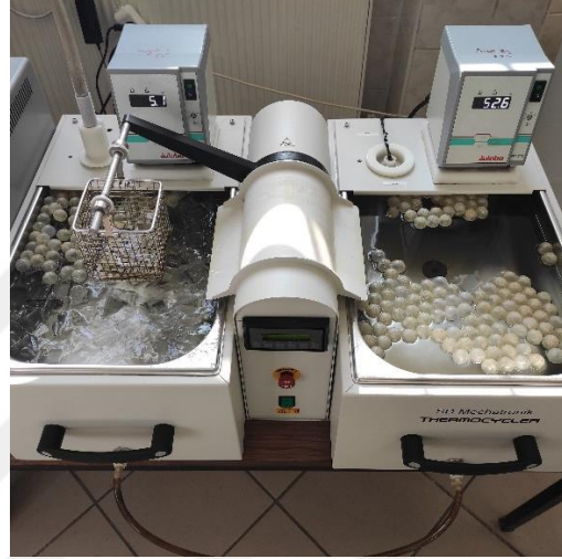
Şekil 4. Thermocycler Sd Mechatronik cihazı
