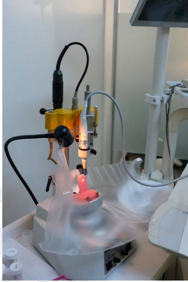
Şekil 11. Ultrasonik enstrümantasyon düzeneği
