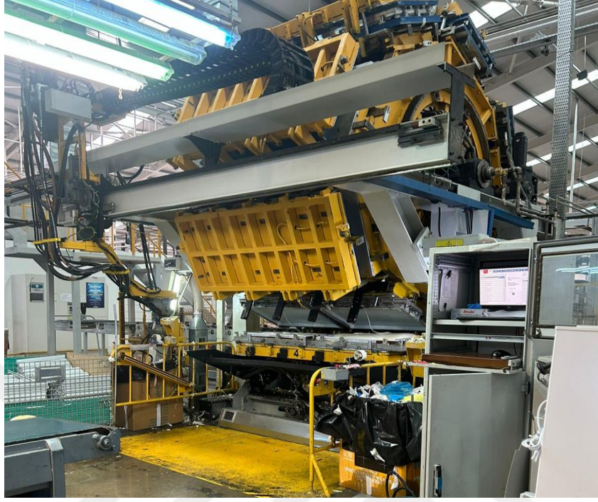
Şekil 5.3. Kapı poliüretan tesisi
