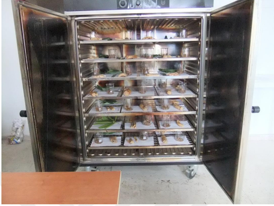
Şekil 9: Deneme alanından alınan örneklerin fırın kurusu haline getirilmesi.
