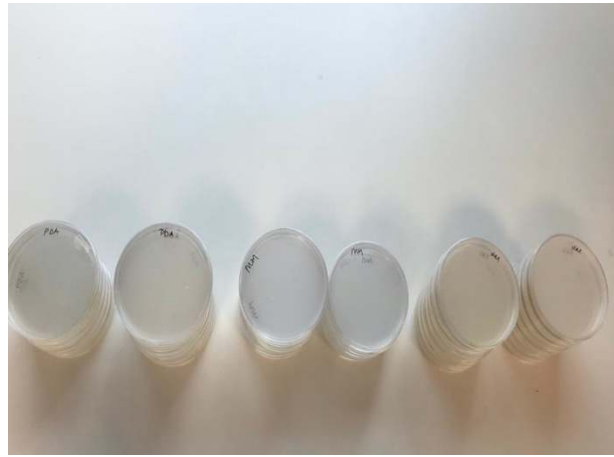
Şekil 3.2. Besiyerlerinin Petri kaplarına dökülmesi ve soğumaya bırakılması
