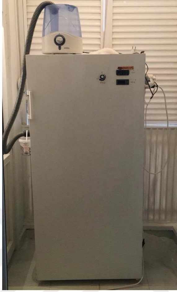
Şekil 3.3. Mantar üretimi için modifiye edilmiş buzdolabı
