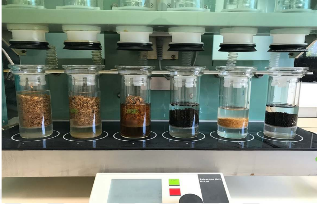
Şekil 3.4. Soxhlet cihazında atık mantar kompostu ekstraksiyonu
