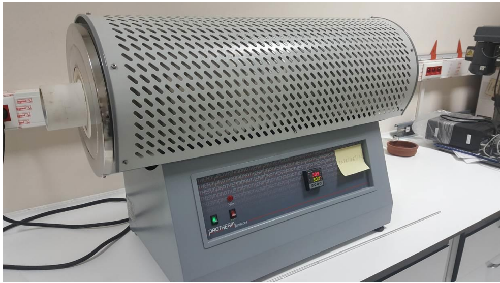
Şekil 3.2 Tavlama işlemi için kullanılan Protherm marka fırın
