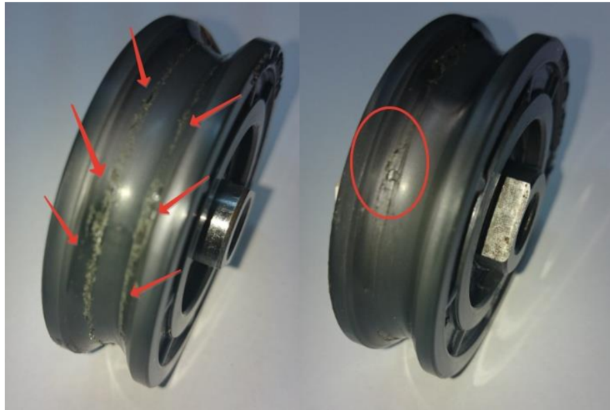
Şekil 7.3 Galvaniz kaplamaya karşı yapılan deneyde makara yüzeyinde görülen aşınma hasarları
