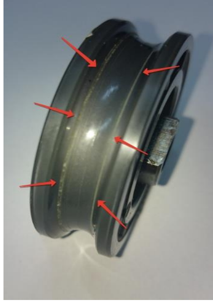
Şekil 7.2 Kataforez kaplamaya karşı yapılan deneyde makara yüzeyinde görülen aşınma hasarı
