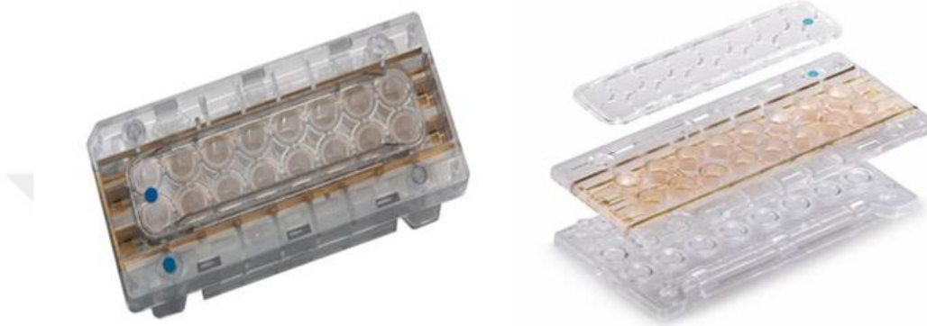
Şekil 3. 2. İnvazyon ve migrasyon çalışmalarında kullanılan 16 kuyucuklu CIM plaka ( https://www.ols-bio.com/xcelligence-r-rtca-esight )
