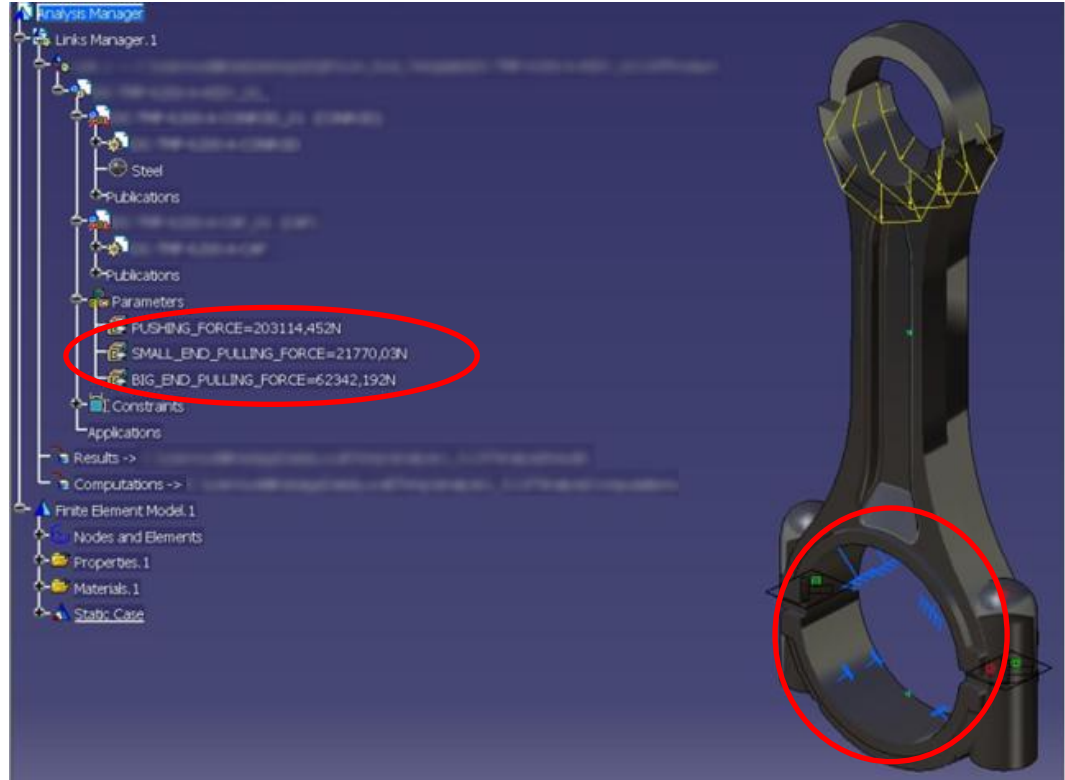
Şekil 7.31 : Biyel tasarımıyla eş zamanlı değişen parametrik input değerleri.
