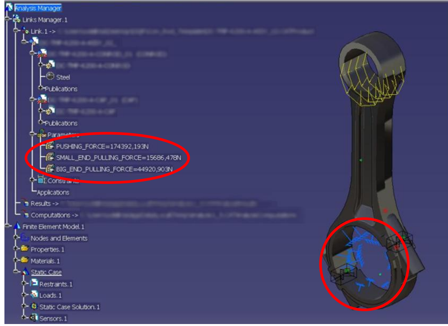
Şekil 7.30 : Biyel tasarımıyla eş zamanlı değişen parametrik input değerleri.
