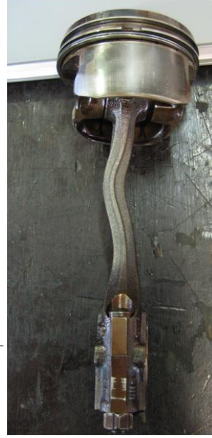
Şekil 3.5 : Eksenler arasındaki paralellik tolerans farkları.
