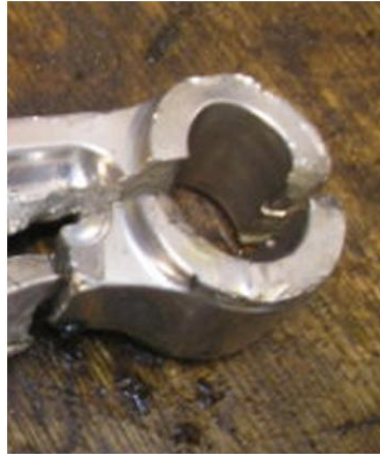
Şekil 3.6 : Kırılmış küçük biyel başı.
