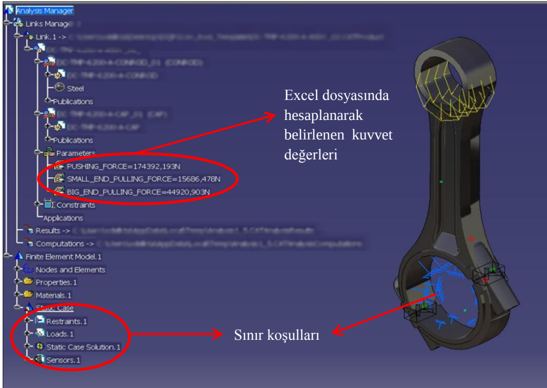
Şekil 7.29 : Analiz sınır koşulları ve kuvvetler.
