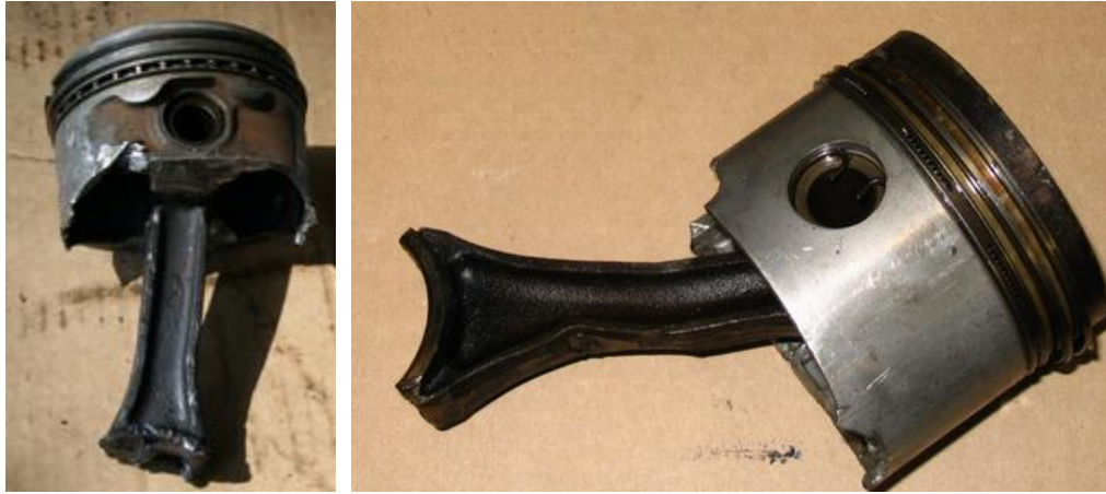
Şekil 3.15 : Kırılmış biyel kolu omuz kısmı.
