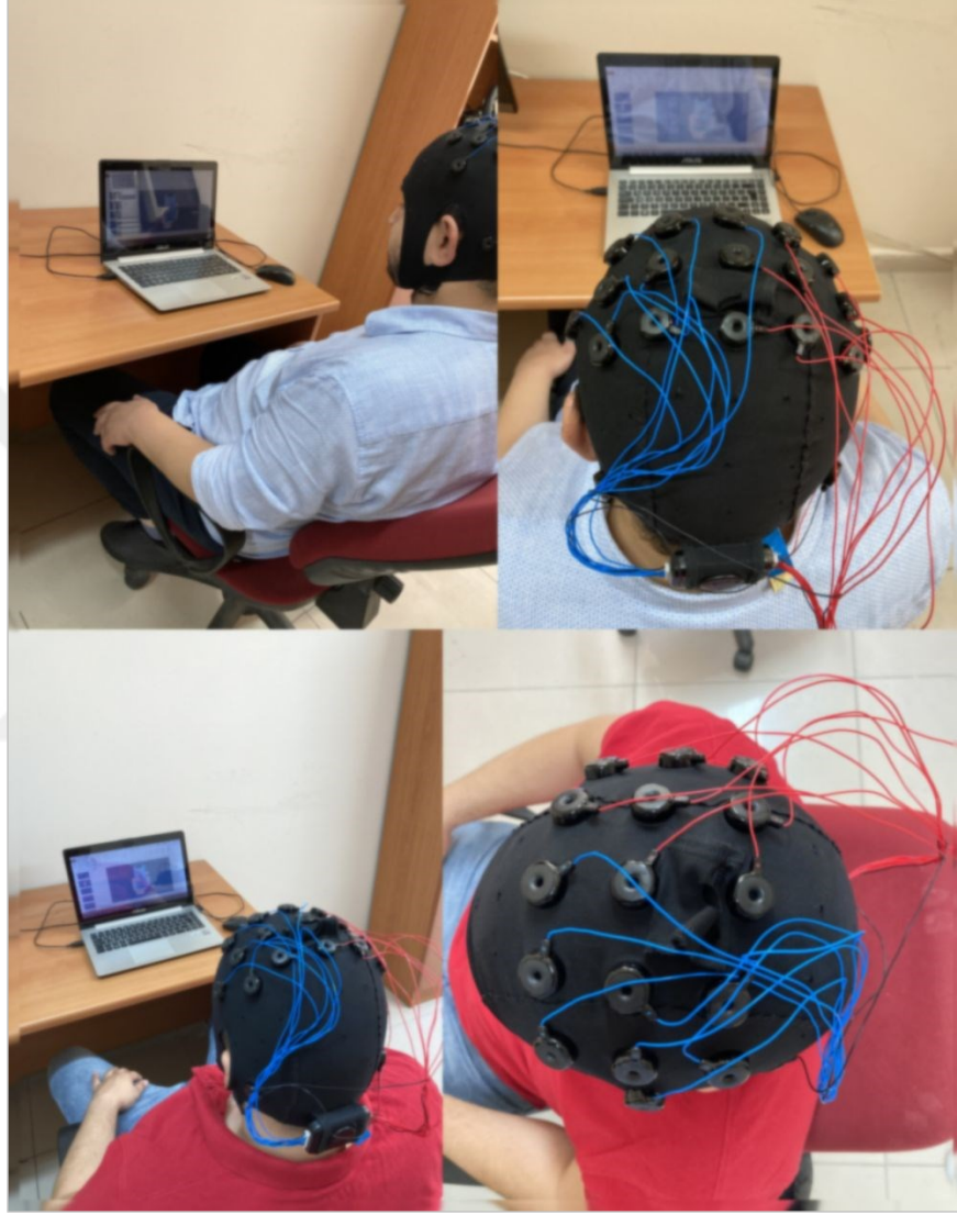
Şekil 2.3. Kayıt alma ortamı ve elektrot sensörlerin yerleştirilme düzeni
