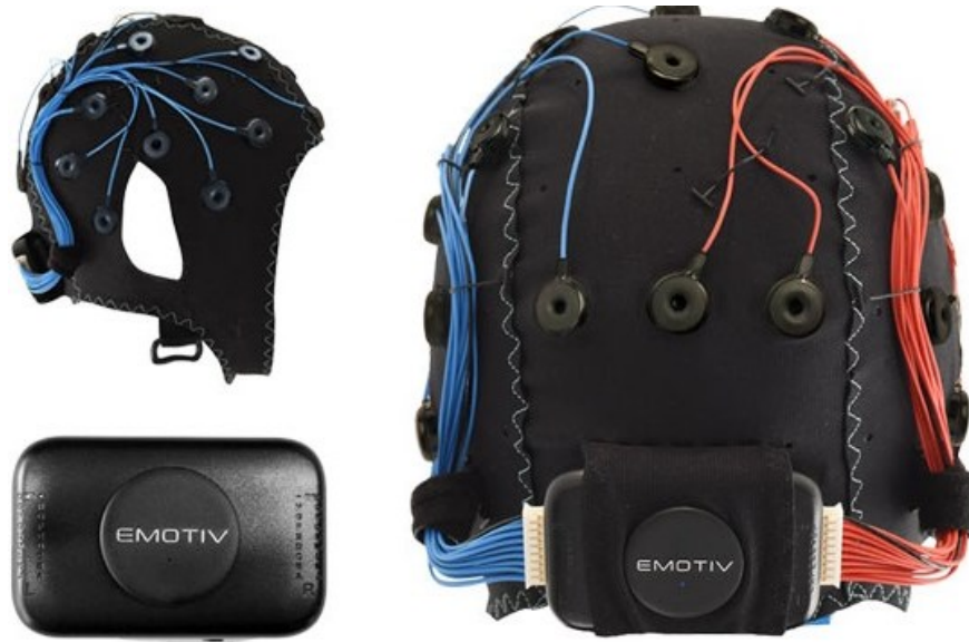
Şekil 1.7. EPOC Flex salin sensör EEG kayıt cihazı seti [67]
