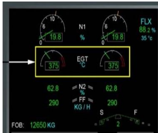
Görsel 5.3. LEAP-1A motorunun EGT gösterimi ( http-17 )
