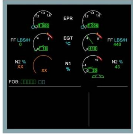
Görsel 5.2. V2500 motorunu kullanan bir A320 birincil motor parametre göstergesi ( http-17 )
