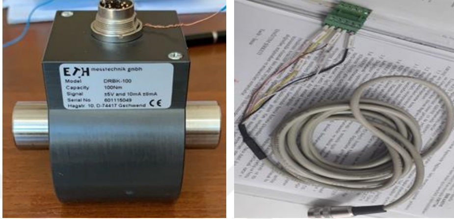
Şekil 3. 30. Tork sensörü ve veri kablosu
