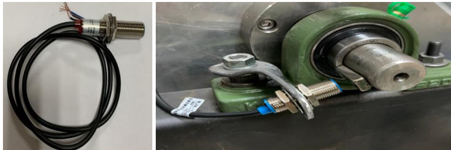
Şekil 3. 31. Kullanılan devir sensörü ve dinamometre miline bağlantısı
