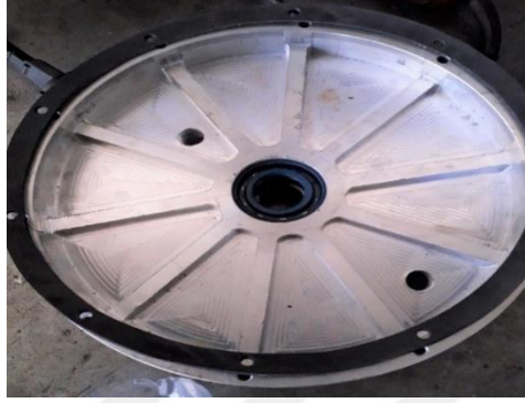
Şekil 3. 23. Stator kapakları arasına lastik conta
