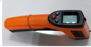
Şekil 3. 40 Sıcaklık ölçümünde kullanılan lazer termometre
