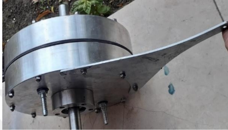
Şekil 3. 25. Dinamometreye tork kolu montajı
