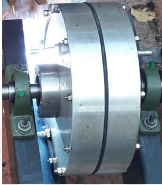
Şekil 3. 27. Rulman yataklarla hidrolik dinamometre montajı
