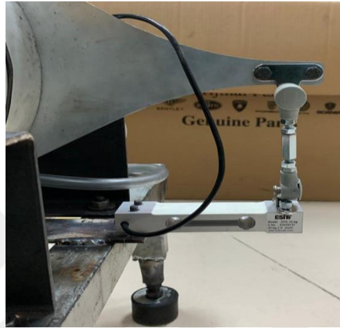
Şekil 3. 33 Platform tipi yük hücresi ve dinamometre bağlantısı
