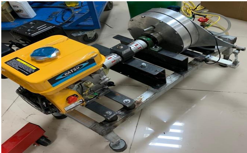
Şekil 3. 34 Dinamometre, motor, tork sensörü ve yük hücresi montajlı deney sehpası
