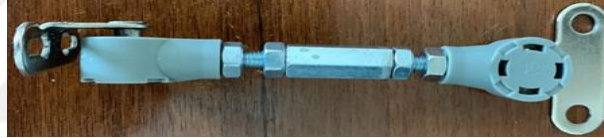
Şekil 3. 32 Yük hücresi ve tork kolu bağlantı mafsalı
