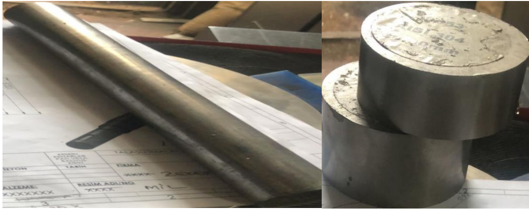
Şekil 3. 13. Mil ve salmastra kutusu için AISI 304 paslanmaz çelik bloklar
