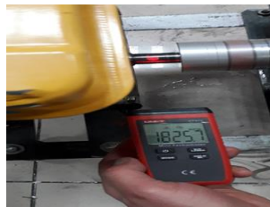
Şekil 3. 41 Devir sayısı kontrolü için lazer takometre
