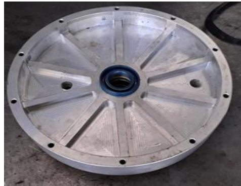
Şekil 3. 22. Sıvı sızdırmaz keçe ve statora montajı
