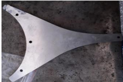
Şekil 3. 18. İmalı gerçekleştirilmiş tork kolu
