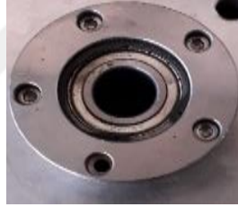
Şekil 3. 21. Statora montajlanmış salmastra kutusu
