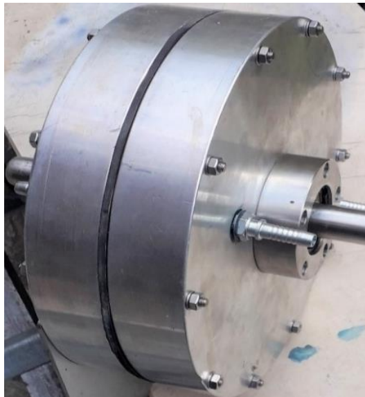
Şekil 3. 24. Montajı gerçekleştirilen hidrolik dinamometre
