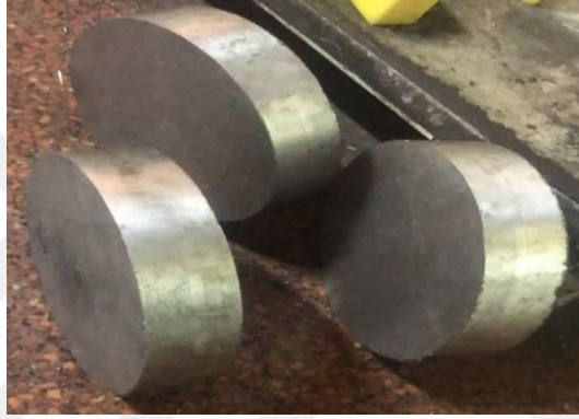
Şekil 3. 12. Rotor ve stator için AA 5083
