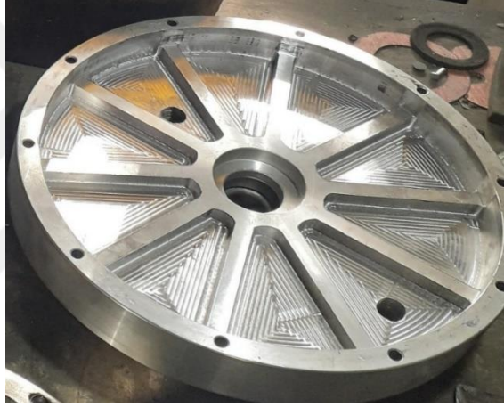
Şekil 3. 15. İmalatı yapılmış alüminyum stator
