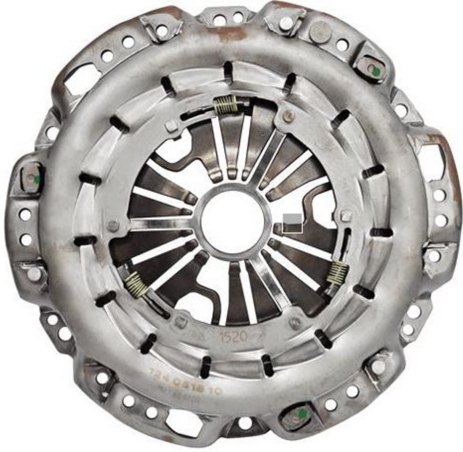
Şekil 5.12 Luk firması SAC isimli ayarlı debriyajı-1 (Luk, 1998)
