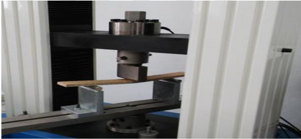
Şekil 22 : Eğilme direnci deneyi.
