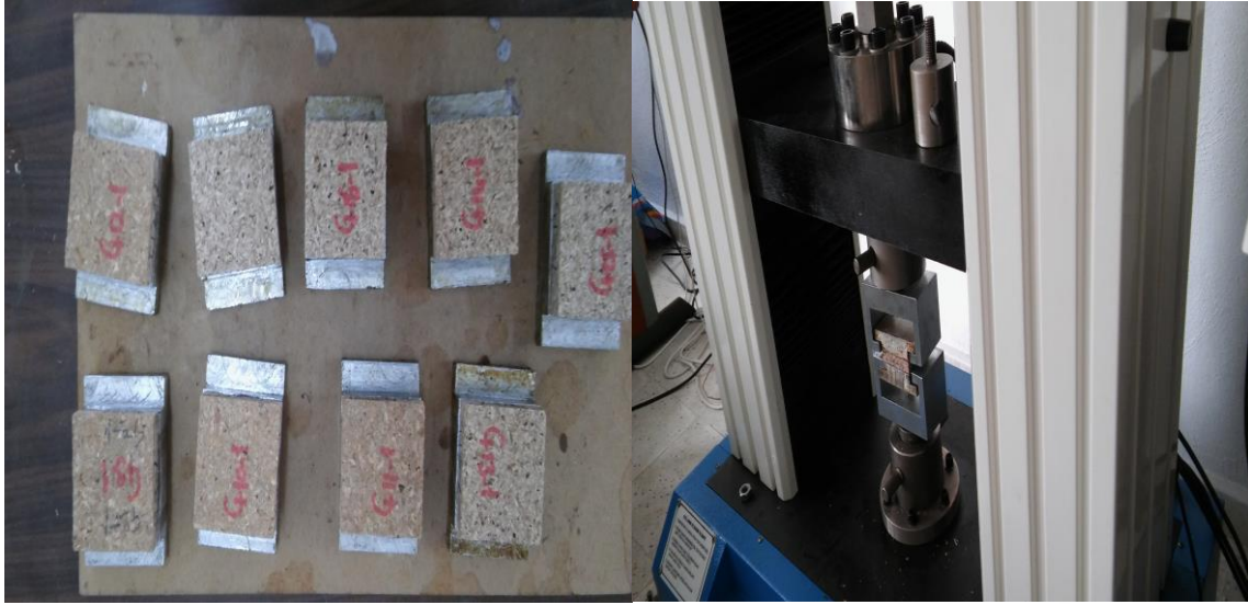
Şekil 23:Yüzeye dik çekme deneyi.
