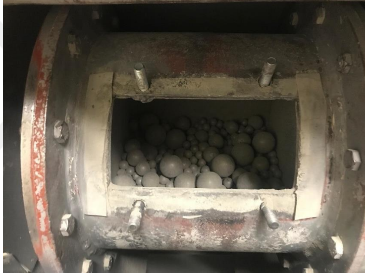
Şekil 2.3 Klinker öğütme değirmeni.
