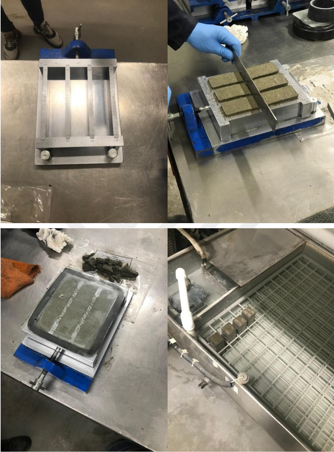
Şekil 2.6 Çimento harcı kalıpları, dökümü ve kürlenmesi.
