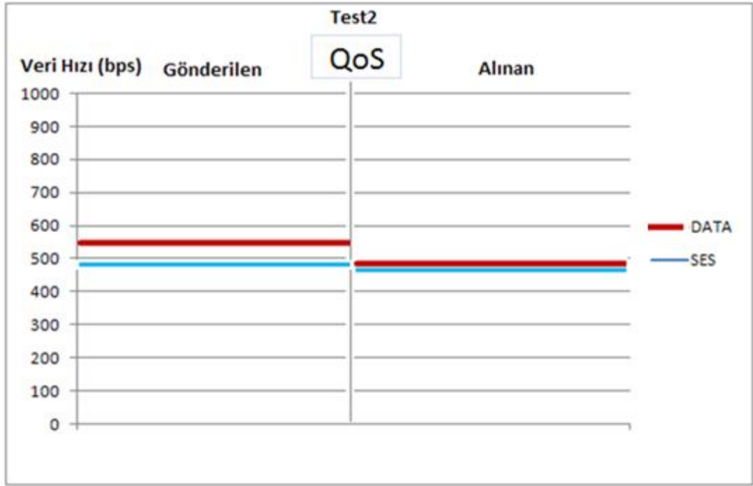
Şekil 6.14. 550 Mbps Veri ve 490 Mbps Ses, toplam gönderilen trafiğin kapasiteyi aşması durumu
