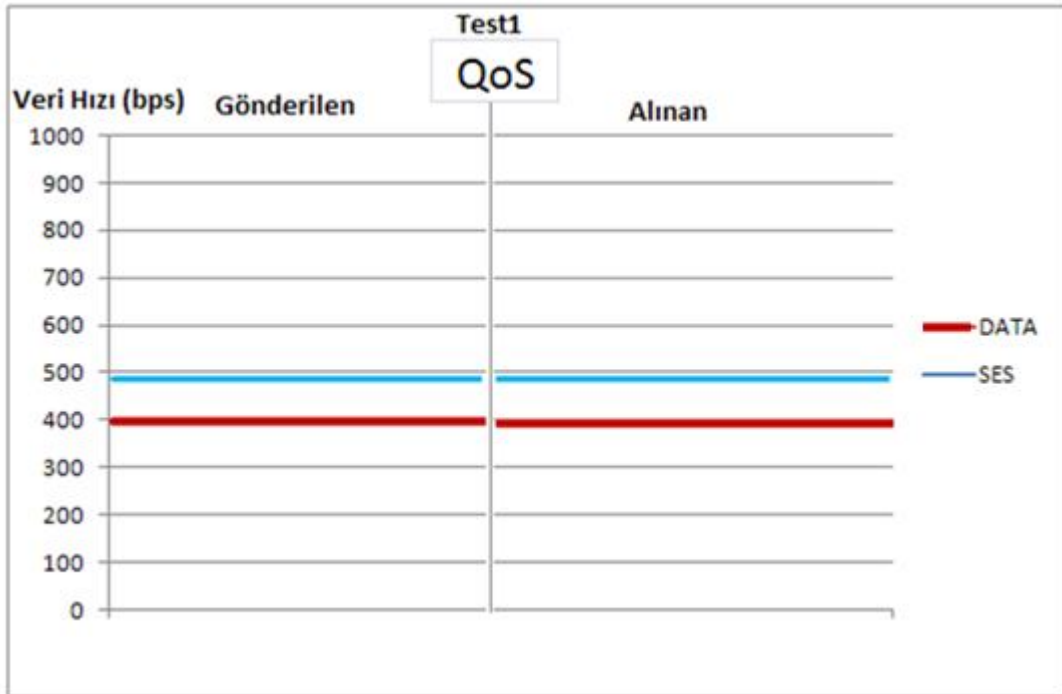
Şekil 6.13. 400 Mbps veri ve 490 Mbps ses, toplamının kapasiteyi aşmadığı durum.
