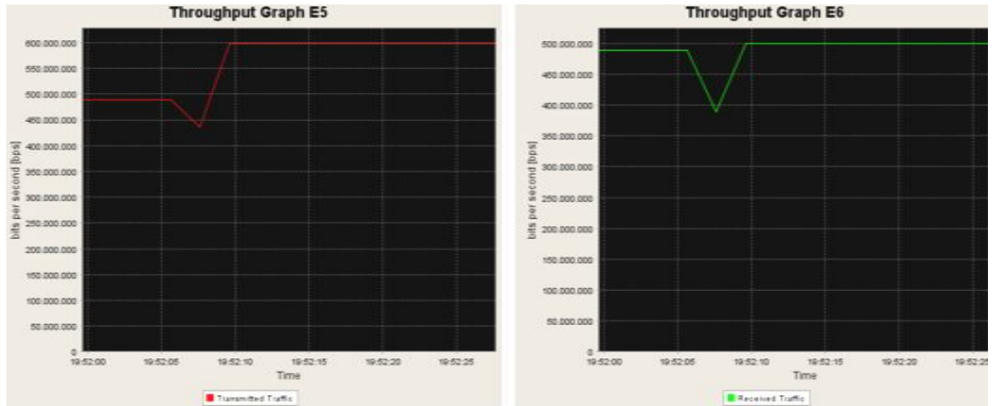
Şekil 1.2 QoS uygulandığı durumda 600Mbps ses gönderildiğinde gönderim ve alım arabirimlerinin ekran görüntüsü
