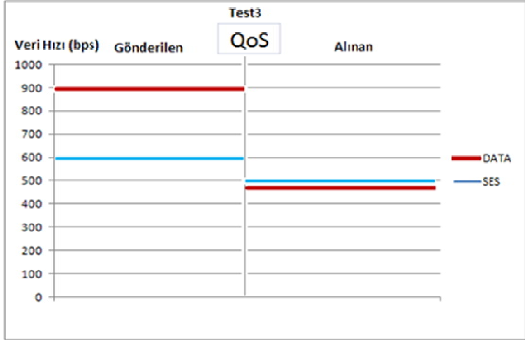
Şekil 6.15. 900 Mbps Veri ve 600 Mbps Ses, toplam gönderilen trafiğin kapasiteyi aşması durumu.
