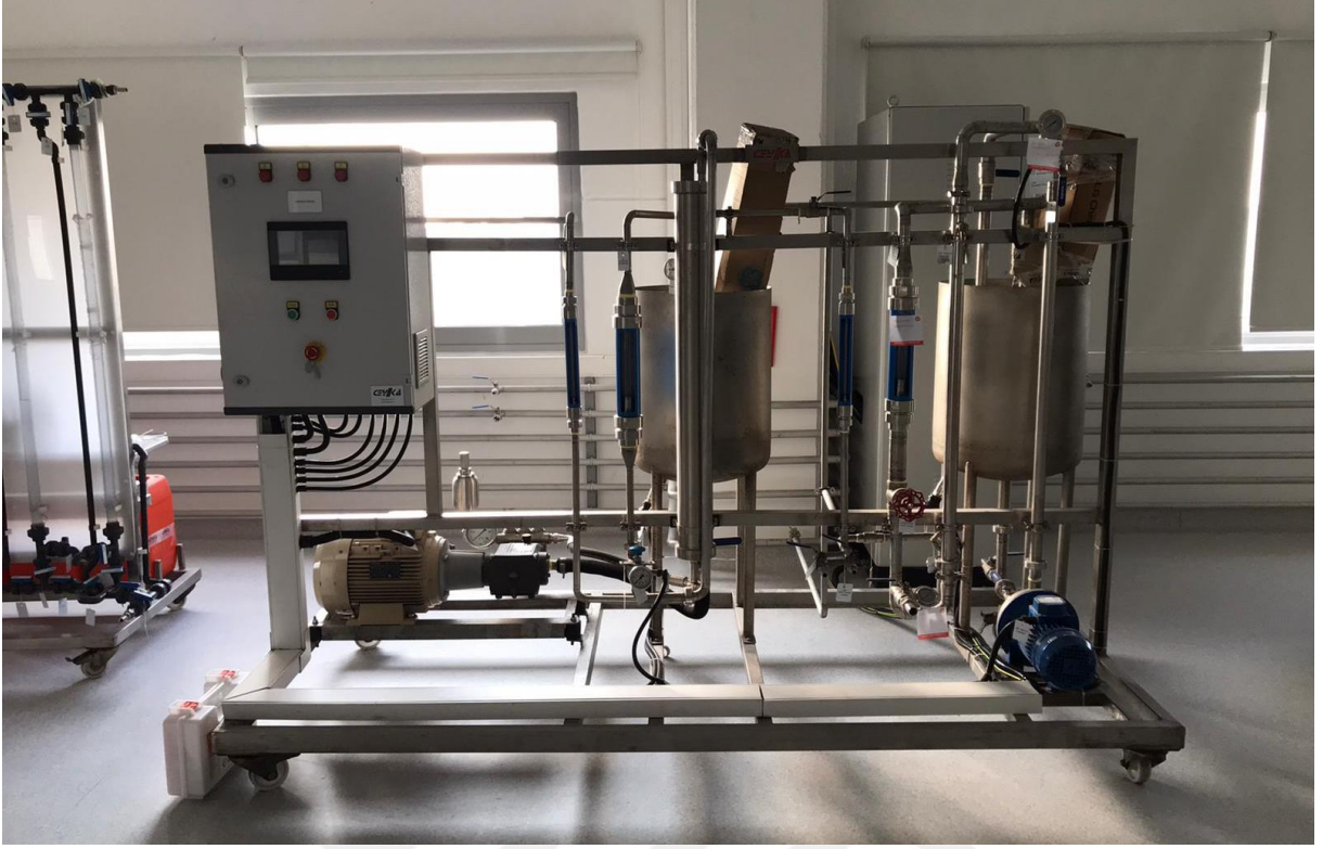
Şekil 3.3. Pilot Nanofiltrasyon Sistemi
