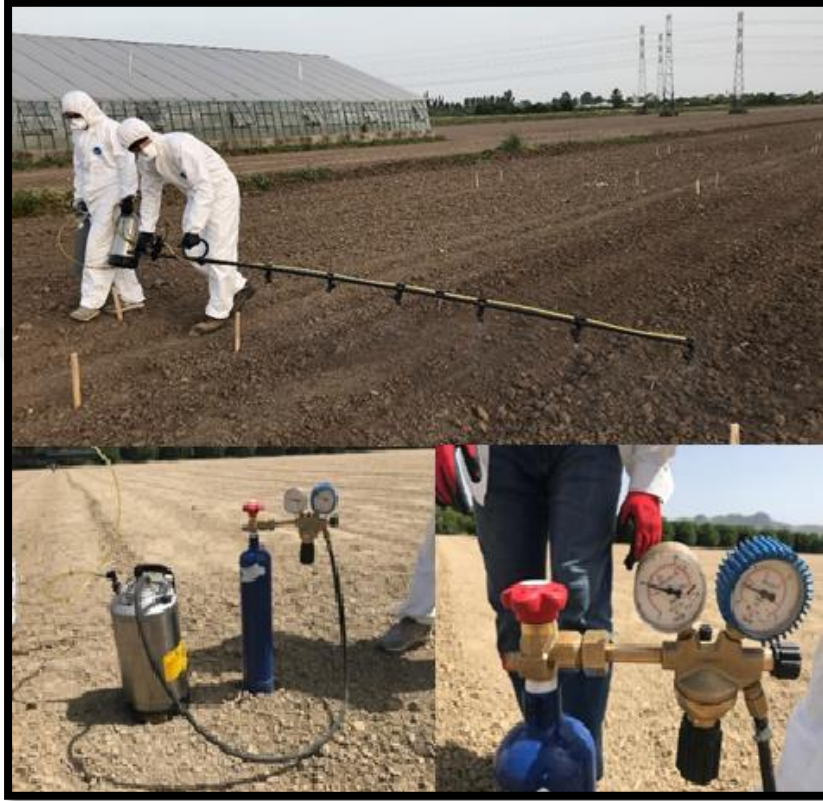
Şekil 3.7. Elde taşınır, gaz basınçlı deneme pülverizatörü
