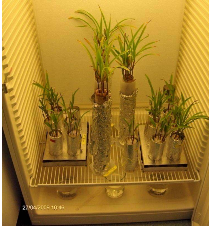
Şekil 2.1. Kök büyümesini gözlemleyebilmek için kağıt rulo sisteminde yetiştirilen bitkilerin lovibond içerisindeki temsili fotoğrafı
