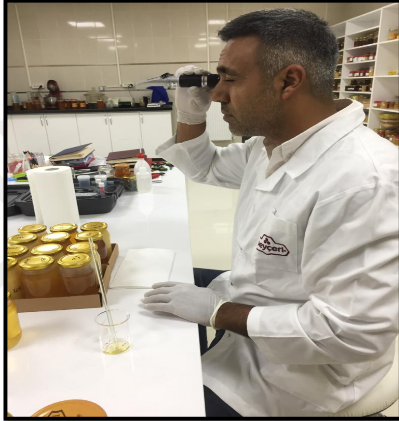
Şekil 3.2. Refraktometre İle Balda Briks ve Nem Tayini Görünümü
