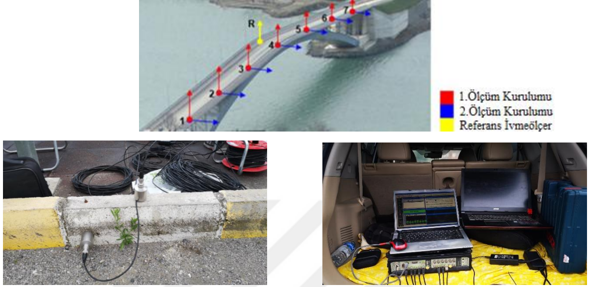
Şekil 2.63. Eynel Köprüsü’ne ait ivmeölçer yerleşim planı
