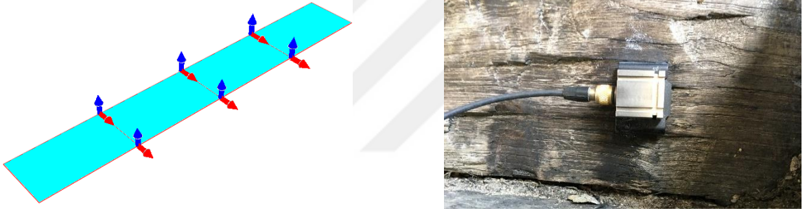
Şekil 2.57. Tarihi Ahşap Buzlupınar Köprüsü’ne ait ivmeölçer yerleşim planı
