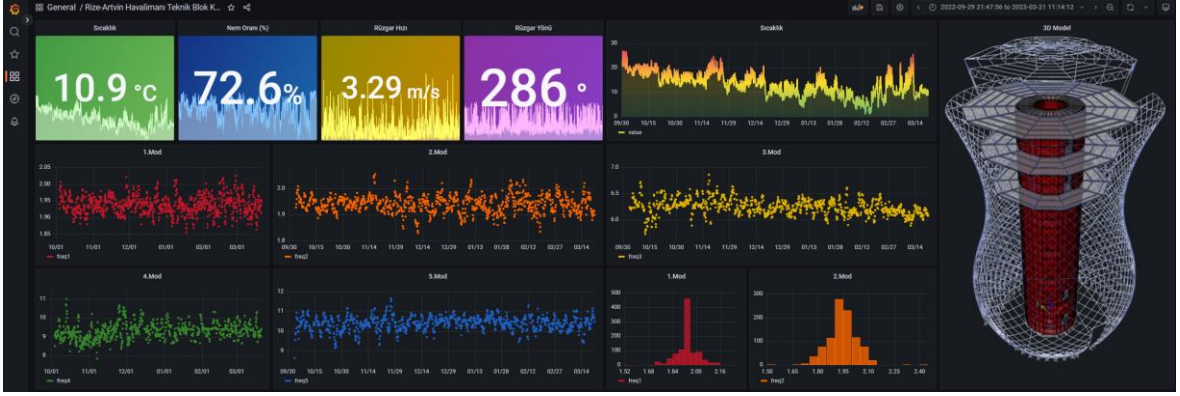
Şekil 2.118. Web Tabanlı Yapı Sağlığı İzleme Platformunda Rize-Artvin Havalimanı Teknik Blok Kule Binası'na ait ana görsel ekranı
