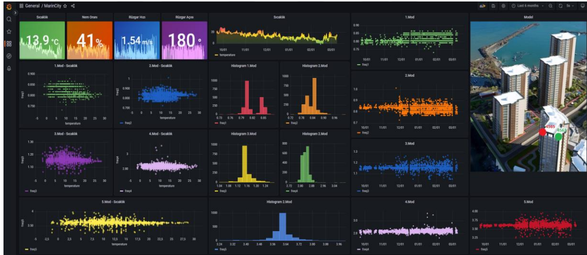
Şekil 2.94. Web Tabanlı Yapı Sağlığı İzleme Platformunda Çok Katlı Betonarme Bina'ya ait ana görsel ekranı
