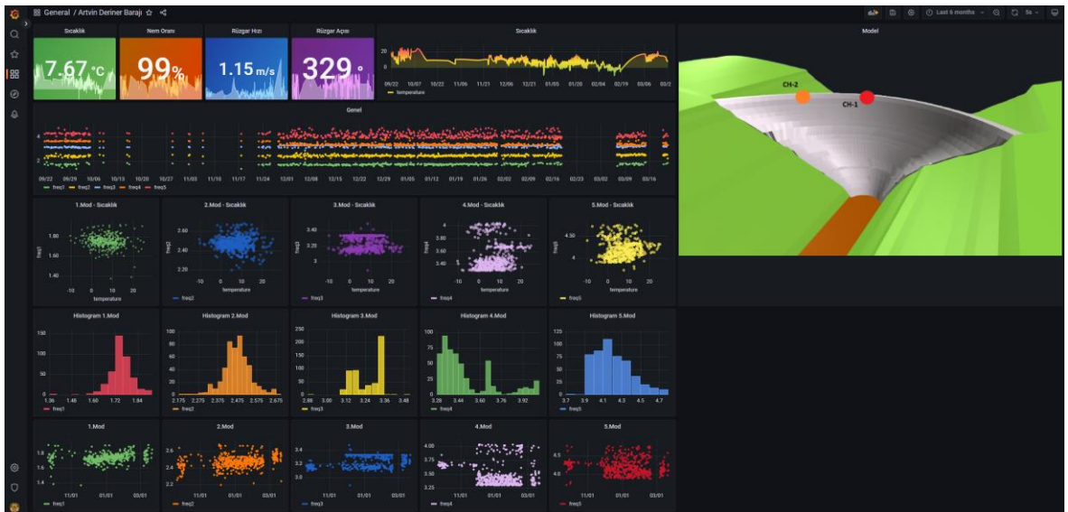
Şekil 2.110. Web Tabanlı Yapı Sağlığı İzleme Platformunda Deriner Barajı'na ait ana görsel ekranı
