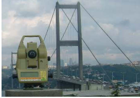
Şekil 5.5 TCA2003 ile 6 numaralı referans noktasından yapılan ölçümden bir görünüm
