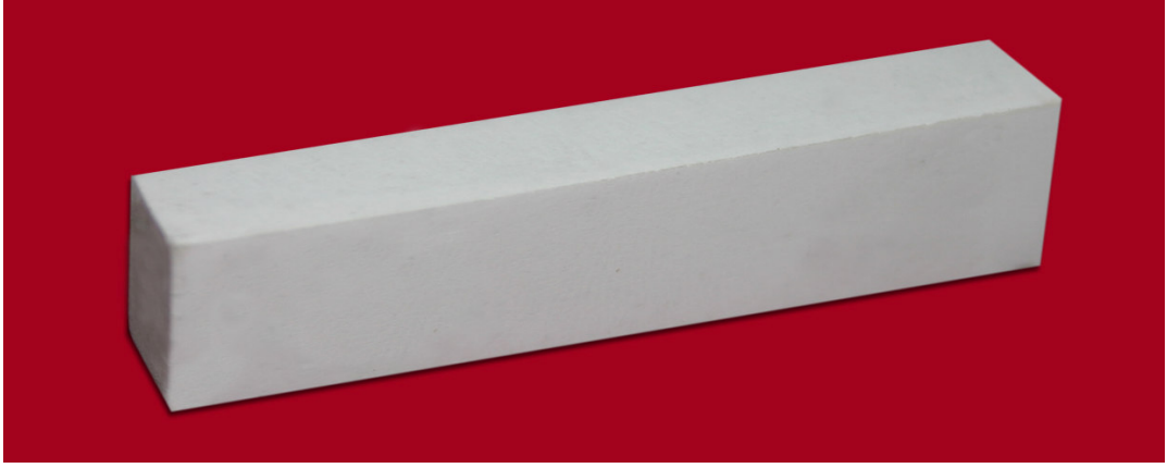
1600 °C’de Sinterlenen Katkısız Alümina Numunesi
