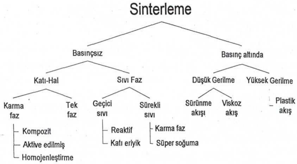
Şekil 2.8 Sinterleme Prosesi Haritası ve Kilit Proses Parametrelerinin Alt Bölümleri (Akgün 2003)
