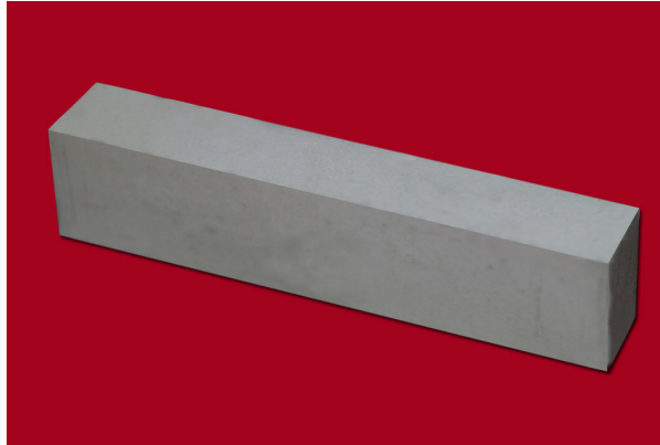
1600 °C’de Sinterlenen %6 mol TiO 2 Katkılı Numune
