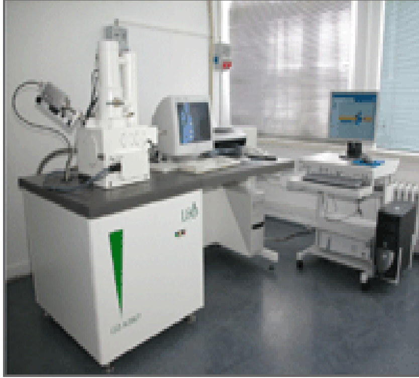
Şekil 3.7 LEO 1430 VP Model SEM Cihazı
