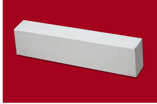
1600 °C’de Sinterlenen %0,5 gr Cr 2 O 3 ve %0,05 gr MgO Katkılı Numuneler
