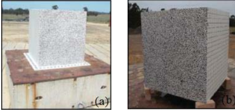
Resim 1.4. Konteynerler (a) Flanşlı konteyner (b) Tamamen kapalı konteyner
