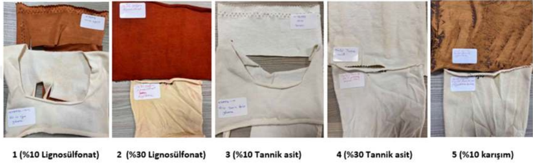
Şekil 4.1: Yıkama öncesi ve sonrası uygulama görünümleri
