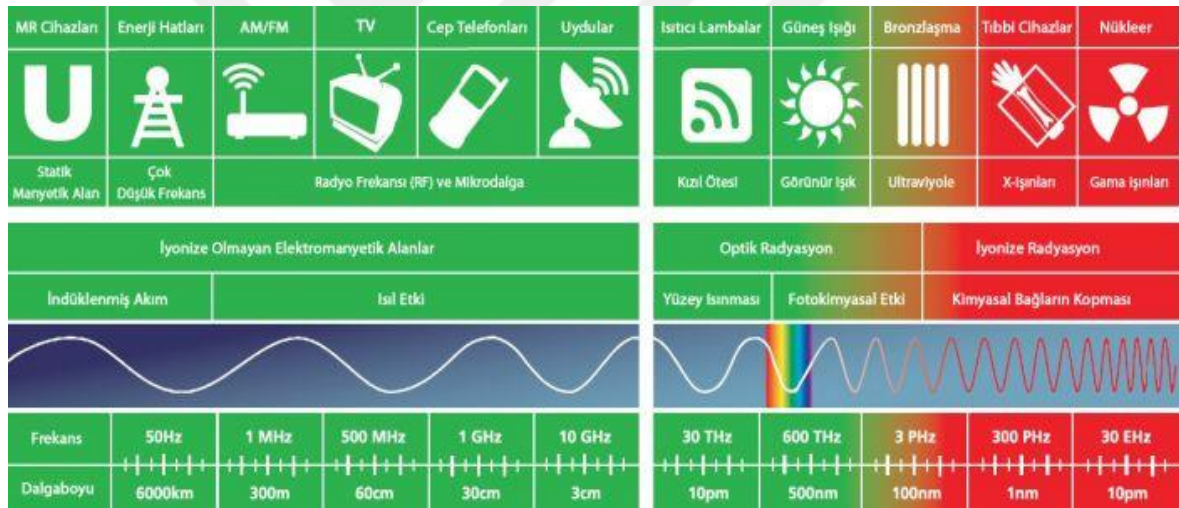
Şekil 1.28. Cihazların elektromanyetik spektrumda gösterilmesi (URL-7, 2018).
