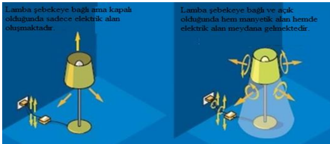
Şekil 1.16. Elektrik alan ve manyetik alanın karşılaştırılması (Güner, 2014).
