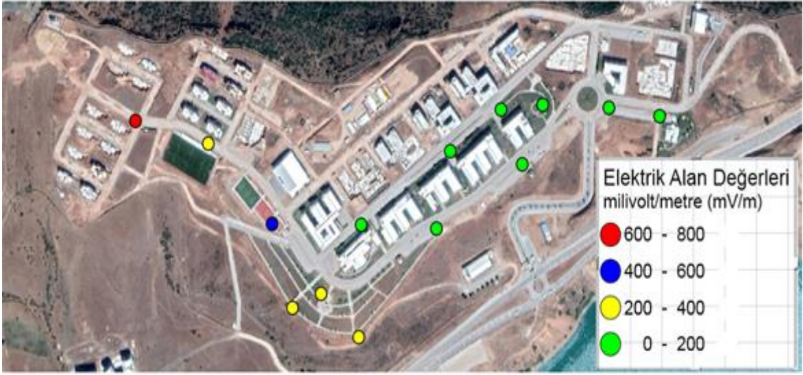
Şekil 3.11. 02.10.2018 tarihine ait maksimum ortalama değerleriyle oluşturulan elektromanyetik alan haritası
