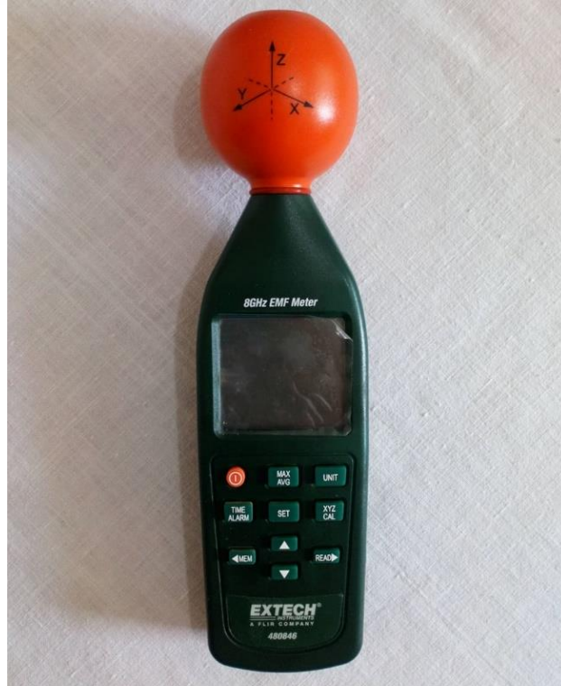
Şekil 2.1. Extech 480846 8 GHz RF elektromanyetik alan ölçüm cihazı
