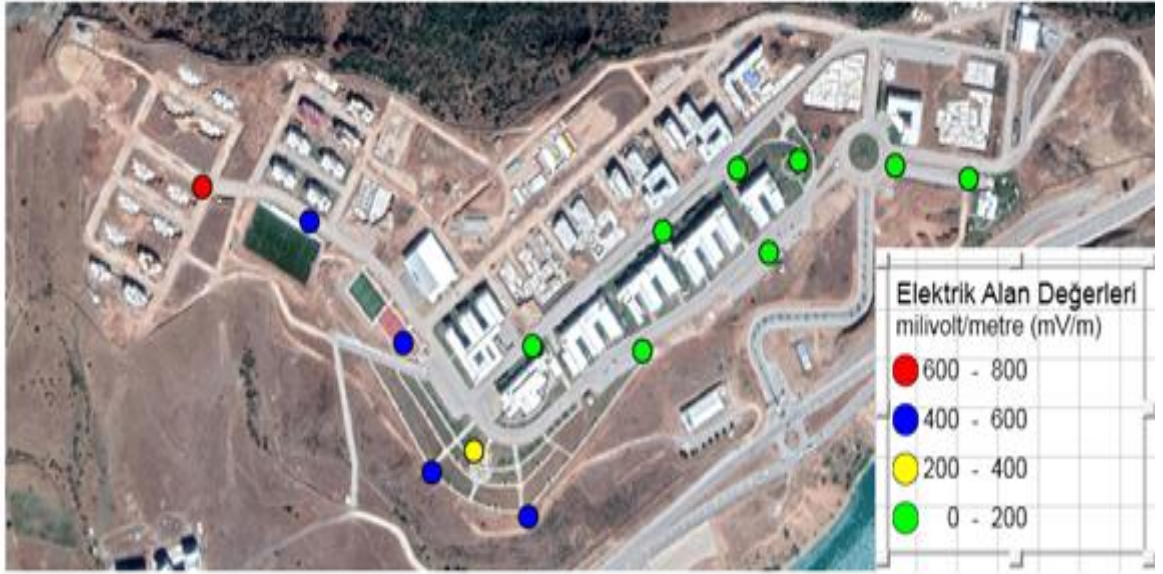
Şekil 3.32. 06.10.2018 tarihine ait anlık maksimum değerlerle oluşturulan elektromanyetik alan haritası
