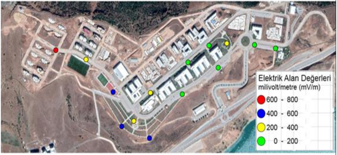
Şekil 3.14. 03.10.2018 tarihine ait anlık maksimum değerleriyle oluşturulan elektromanyetik alan haritası
