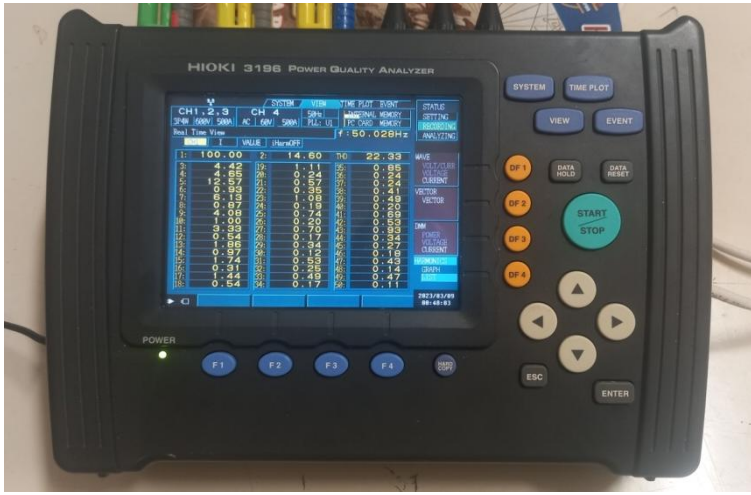
Şekil 2.2. Hioki 3196 güç kalitesi analizörü
