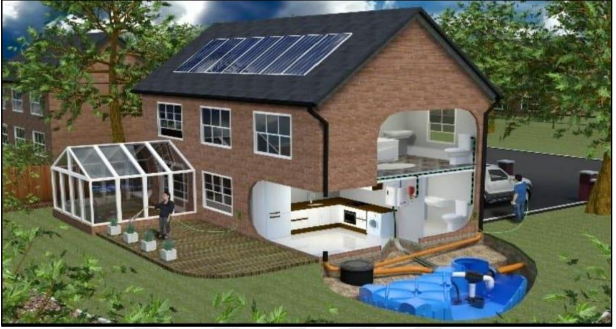
Şekil 2.7. Yağmur suyu toplama sistemi (Buçak, 2015).
