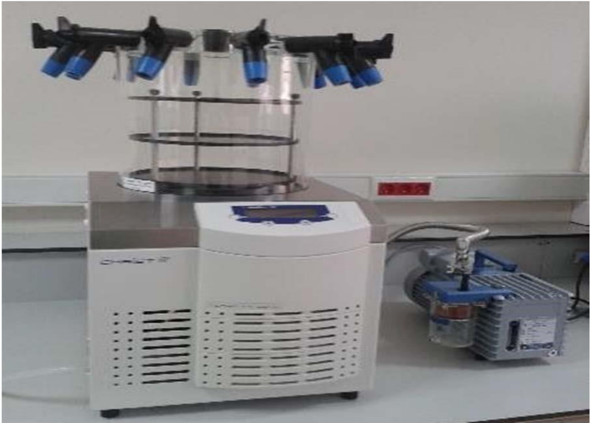
Şekil 3.1. Mürdüm eriği meyvesini kurutmak için kullanılan liyofilizatör cihazı.
