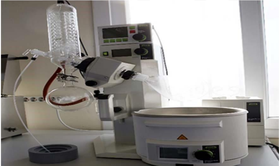
Şekil 3.3. Meyve özütleri elde etme işlemlerinde kullanılan evaporatör.
