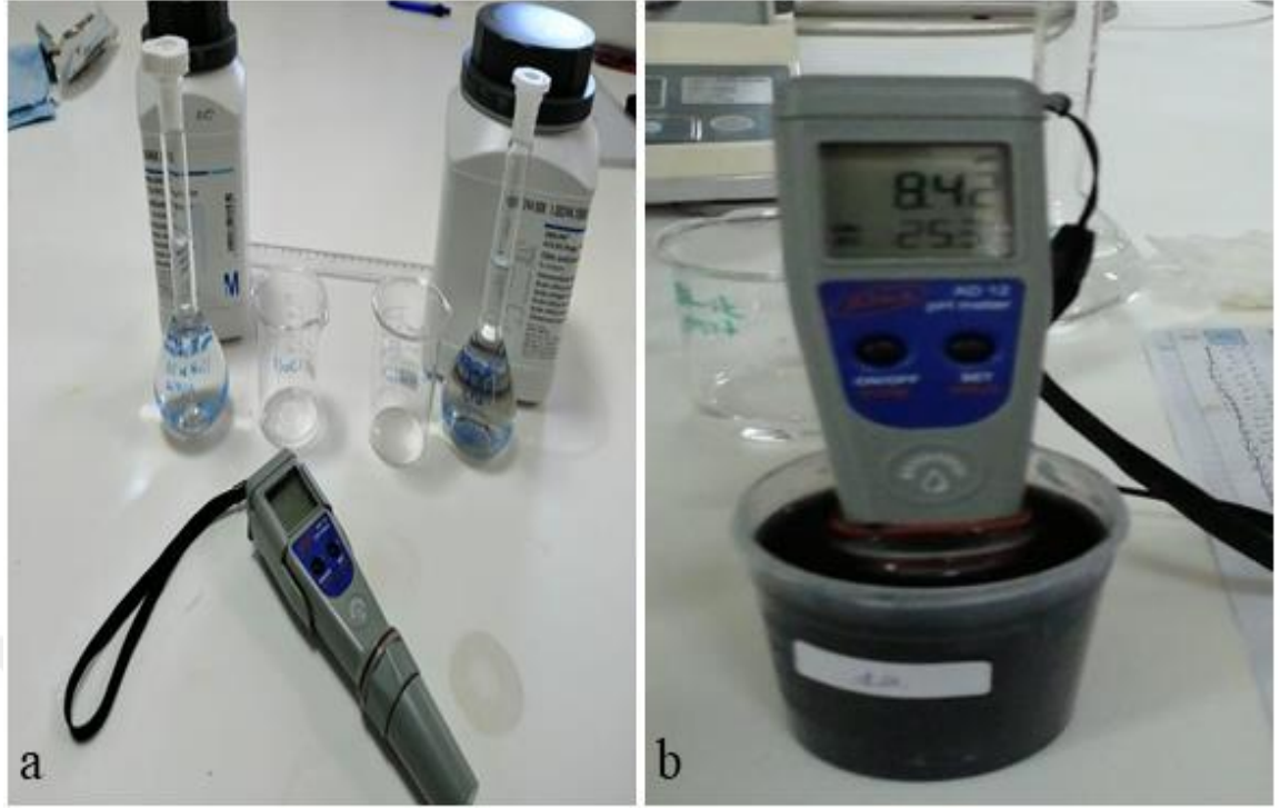
Şekil 3.4. a) Tampon çözeltiler (0.1 N sitrik asit ve 0.1 N sodyum hidroksit) ve pH metre b) Solüsyonların pH metre ile ölçümü
