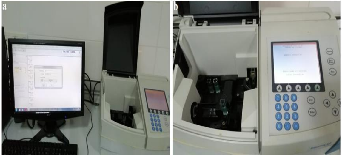
Şekil 3.12. Antioksidan analizinin spektrofotometre ölçümleri
