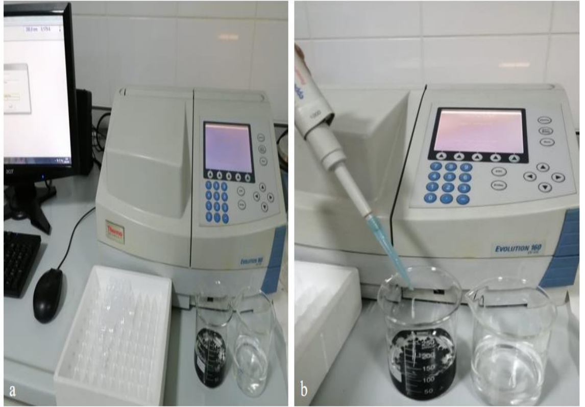
Şekil 3.9. Enkapsülasyon verimliliği analizinin spektrofotometre ölçümleri
