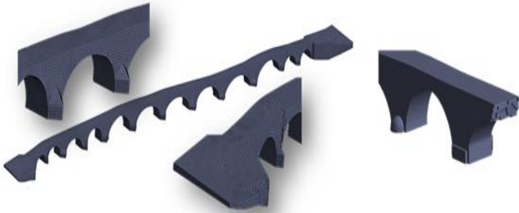
Şekil 3.4. Tarihi Murat Köprüsü Modeli ve Mesh Görüntüsü
