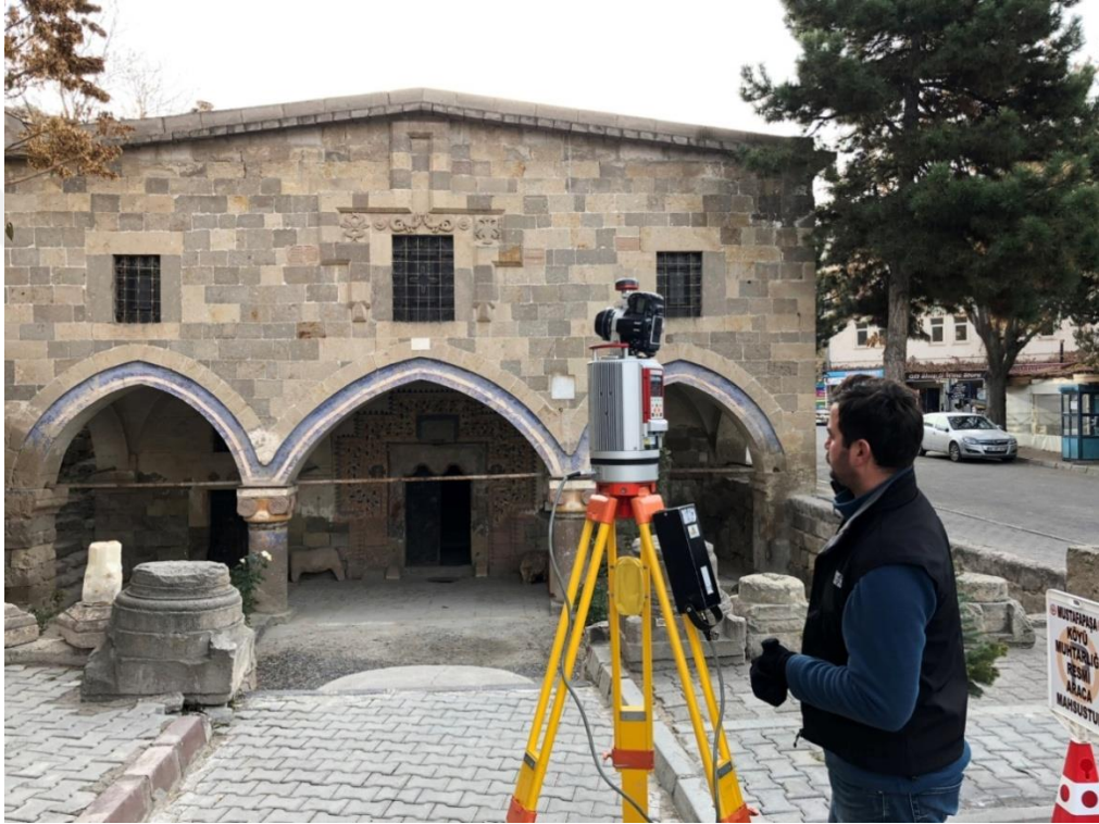
Şekil 5.8. 3D Lazer tarayıcı ile yapının ölçülmesi
