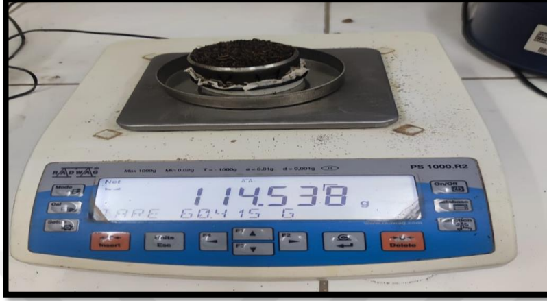
Şekil 3. 14. Ortamların hacim ağırlığı ölçüm görseli
