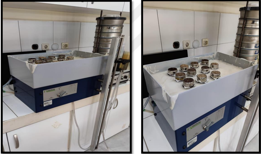
Şekil 3. 13. Farklı tansiyon değerlerinde yetiştirme ortamlarında tutulan su miktarı tayini görselleri
