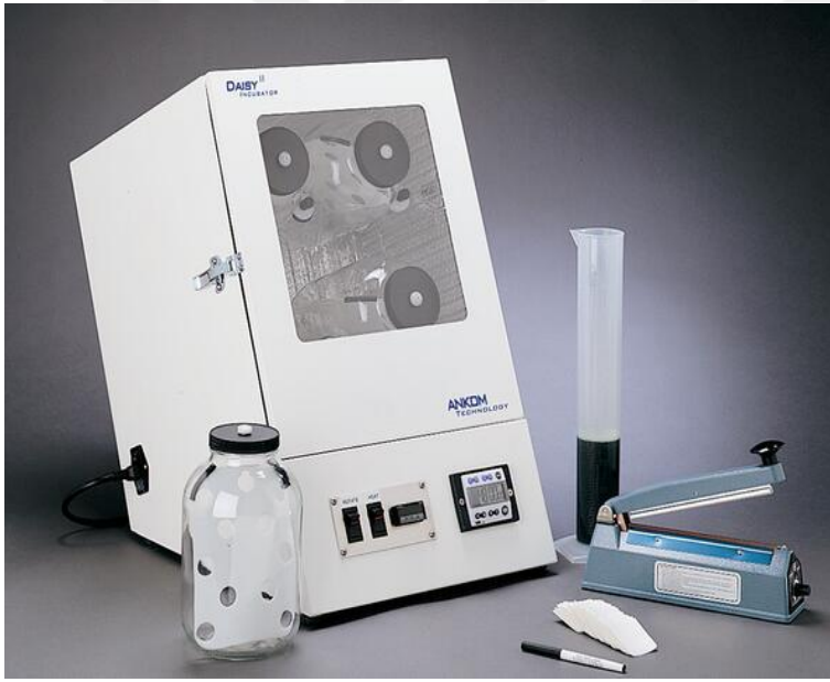
Şekil 2.4. Daisy İnkübatör Cihazı, Kese, Kavanoz ve Heat Sealer (Ankom Technology Corporation Fairport, New York, NY, USA).
