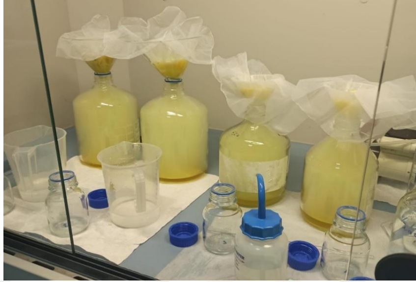
Şekil 4.6. Çeşitli konsantrasyonlarda \text{NaO}_2\text{Cl} çözeltisi kullanılarak MKS üretimi yapılması
