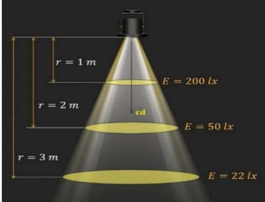
Şekil 2.10 Aydınlanma düzeyi ve mesafe ilişkisi (Alvisi 2023)
