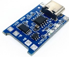
Şekil 3.16 Pil şarj ve akım koruma BMS modülü TP4056
