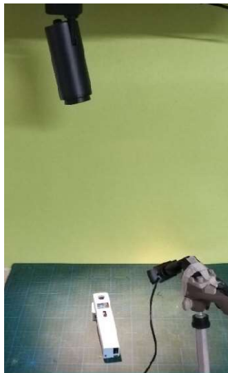
Şekil 4.1 Aydınlatma test düzeneği
