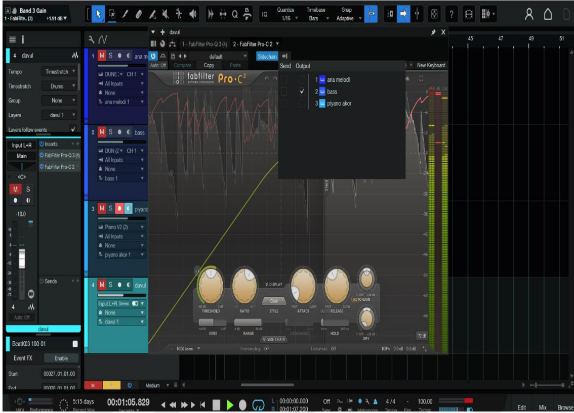
Şekil 18. Side-chain Kompresör Tekniği
