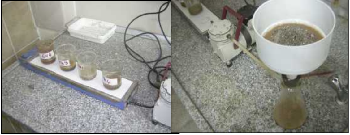
Şekil 3.89.Tarihi harç numunelerde yapılan asit kaybı deneyi
