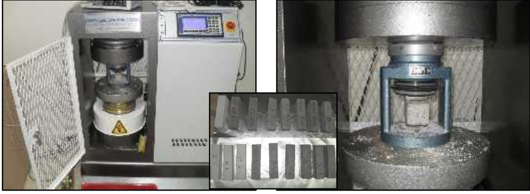
Şekil 3.103. Tek eksenli basınç dayanımı deneyi (tuğla ve onarım harçlarında)
