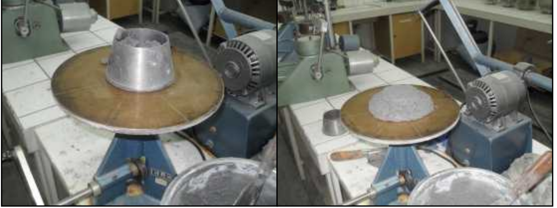
Şekil 3.112. Harç kıvam tayini (yayılma tablası)
