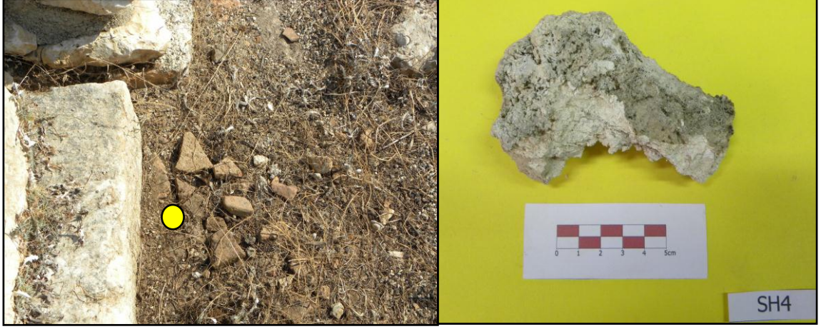
Şekil 3.53. SH4 kodlu zemin tuğla harcı numunesi
