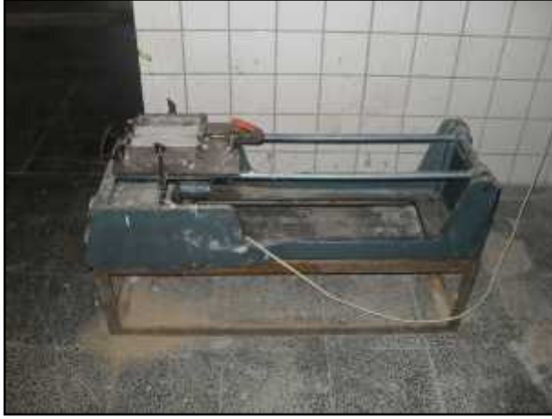
Şekil 3.111. Harç sarsma tablası
