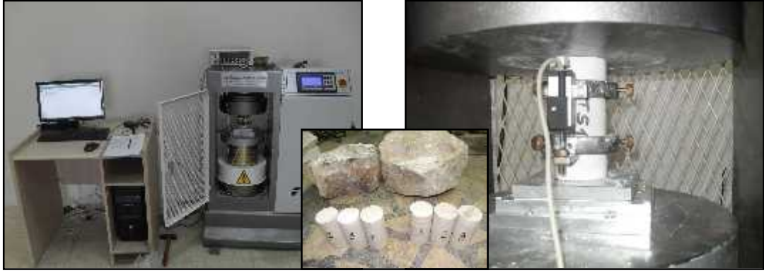
Şekil 3.104. Tek eksenli basınç dayanımı deneyi (taşlarda)
