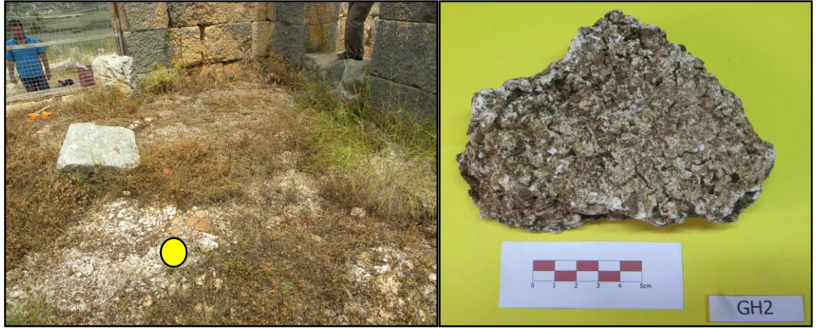
Şekil 3.20. GH2 kodlu tuğla zemin harcı numunesi (murex harcı)
