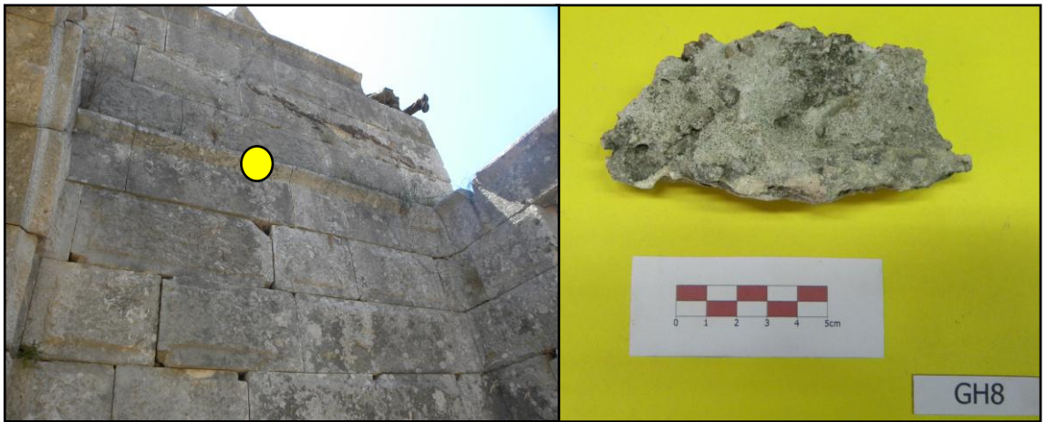
Şekil 3.27. GH8 kodlu çatı yalıtım harcı numunesi
