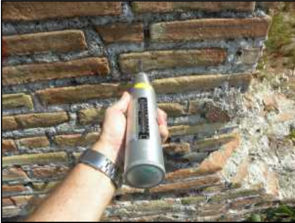
Şekil 3.108. Schmidt çekici deneyi
