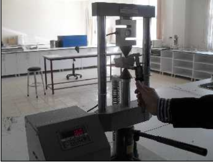
Şekil 3.102. Nokta yükleme (point-load) deneyi
