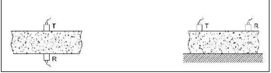
Şekil 3.106a Ultrases doğrudan ölçüm
