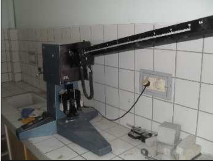
Şekil 3.105. Eğilmede çekme dayanımı deneyi
