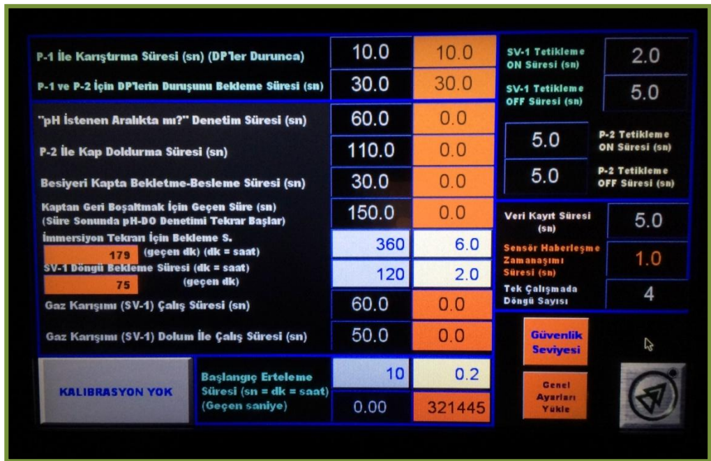
Şekil 4.55 Biosis balon tip geçici daldırma reaktörü özel yazılım ayar ekranı
