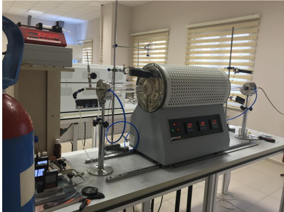
Şekil 4.1. Deneyleri gerçekleştirdiğimiz FCCVD sistemi.
